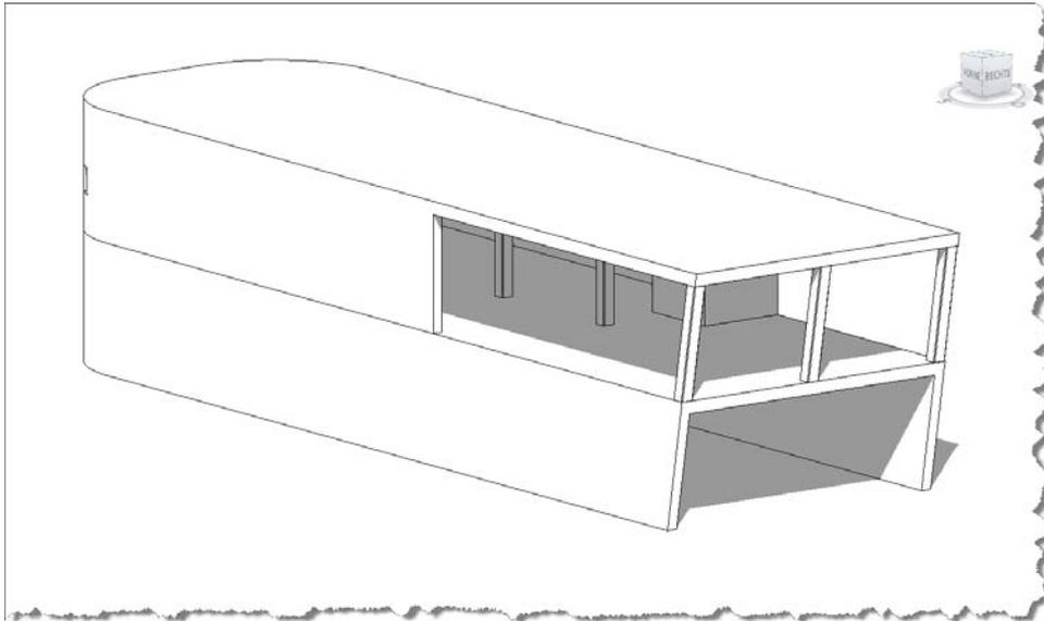
Die Stützendarstellung kann für den Detaillierungsgrad Grob und Mittel bzw. Fein zwischen einer Darstellung ohne und mit gefasteten Kanten eingestellt werden.
