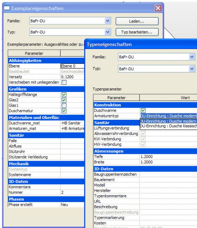
In den Typenparametern steckt die (für behindertengerechte Duschen obligatorische) Größe 1.20 x 1.20. Außerdem können Sie zwischen der modernen Armatur und der klassischen mit Schlauch und Duschkopf wählen, und Sie können die Duschwanne ausschalten, so dass eine Absenkung des Bodenbelags (über Bearbeiten der Geschosdecke) erzeugt werden kann
