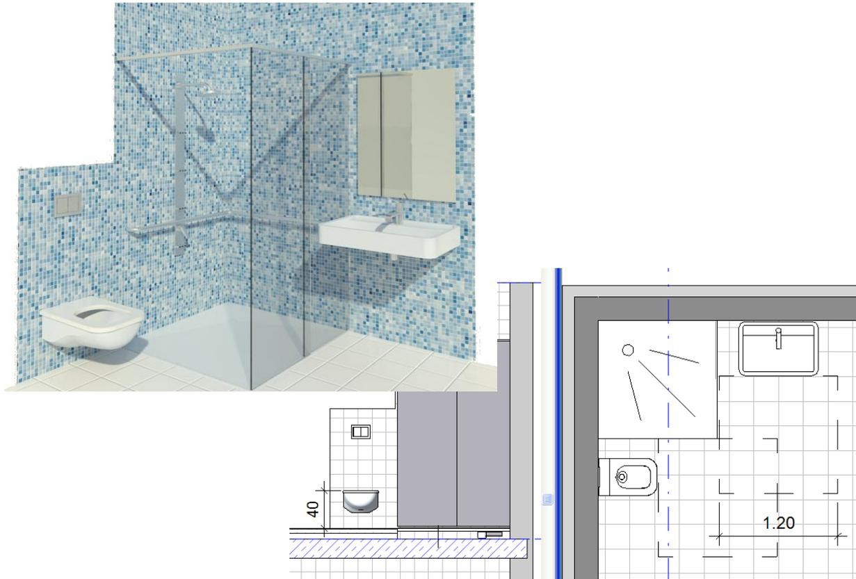
Mit diesen Familien können Sie barrierefreie Sanitärräume möblieren. Dabei kann wenn notwendig ein Bewegungsraum im Grundriss eingeblendet werden. Die Abwasserinstallation bei der bodenebenen Duschwanne wird im Schnitt dargestellt, so dass Sie die notwendigen Fußbodenhöhen kontrollieren können.
