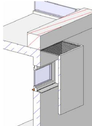
Die Solarzellen werden über den Befehl "Bauteil" auf eine Ebene oder eine Fläche (z.B. Dachfläche) positioniert. Auswahl hierfür erfolgt wie gewohnt über die Optionsleiste. Der Lichtschacht ist ein wandbasierendes Bauteil und kann daher mit dem Befehl "Bauteil" an eine Wand angebracht werden.
