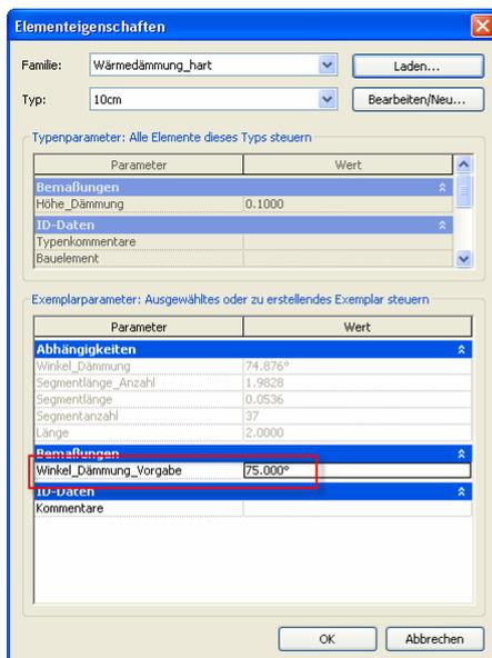
Die Abdichtungsbahn sollte immer eine Länge von mindestens 3 Segmenten aufweisen. Kürzere Elemente müssen über "Gefüllte Bereiche" erstellt werden. Die Spiegelsymbole ermöglichen ein "Umkehren" der Abdichtungsbahn. So kann auf einfache Art gesteuert werden, auf welcher Seite und mit welchem Segment die Abdichtungsbahn beginnt.
