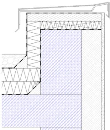
Die Abdichtungsbahn und die Wärmedämmung\_hart werden über den Befehl Detailelemente als Detailelemente eingefügt werden. Es handelt sich dabei um Linienwerkzeuge. Sie können also z.B. gestutzt oder über die Steuerelemente verändert (gezogen) werden. Als Detailelemente sind diese Zeichnungselemente immer nur in der Ansicht sichtbar, in der sie erstellt wurden. Sie eignen sich hervorragend zum Ausarbeiten von Detailpunkten.
