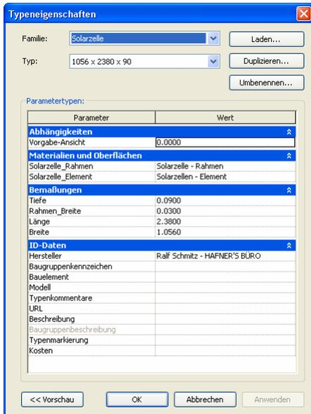
Die Parameter der Familien sind selbsterklärend und können beliebig verändert werden. So können beispielsweise verschiedene Typen für Solarzellen und deren unterschiedliche Abmessungen erstellt werden.
