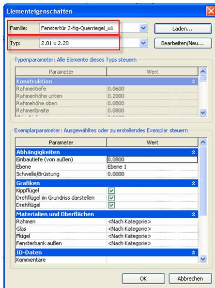
Über die Exemplarparameter bzw. die Elementeigenschaften werden die gewünschte Familie und der gewünschte Typ ausgewählt. Die mitgelieferten Textdateien ermöglichen ein schnelles Importieren verschiedener Typen. Bei Bedarf können mit Hilfe der Textdatei weitere Standardtypen erstellt werden.
