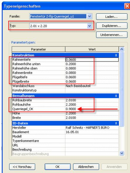
Über die Typenparameter werden alle Abmessungen des jeweiligen Typs gesteuert. Durch Duplizieren eines vorhandenen Typs können weitere Typen erstellt werden.
